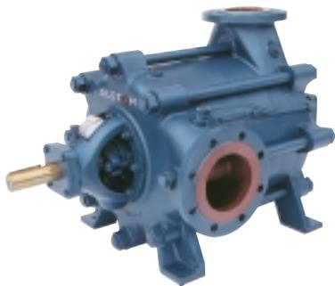
Las bombas PLUTON, son del tipo multietapa con eje horizontal. Carcaza en hierro fundido. Rodete tipo cerrado, radial de bronce o acero inoxidable con anillos de desgaste del lado delantero y del trasero con agujeros para alivio del empuje axial. La estanqueidad del eje es con empaquetaduras u opcionalmente con sellos mecánicos.
